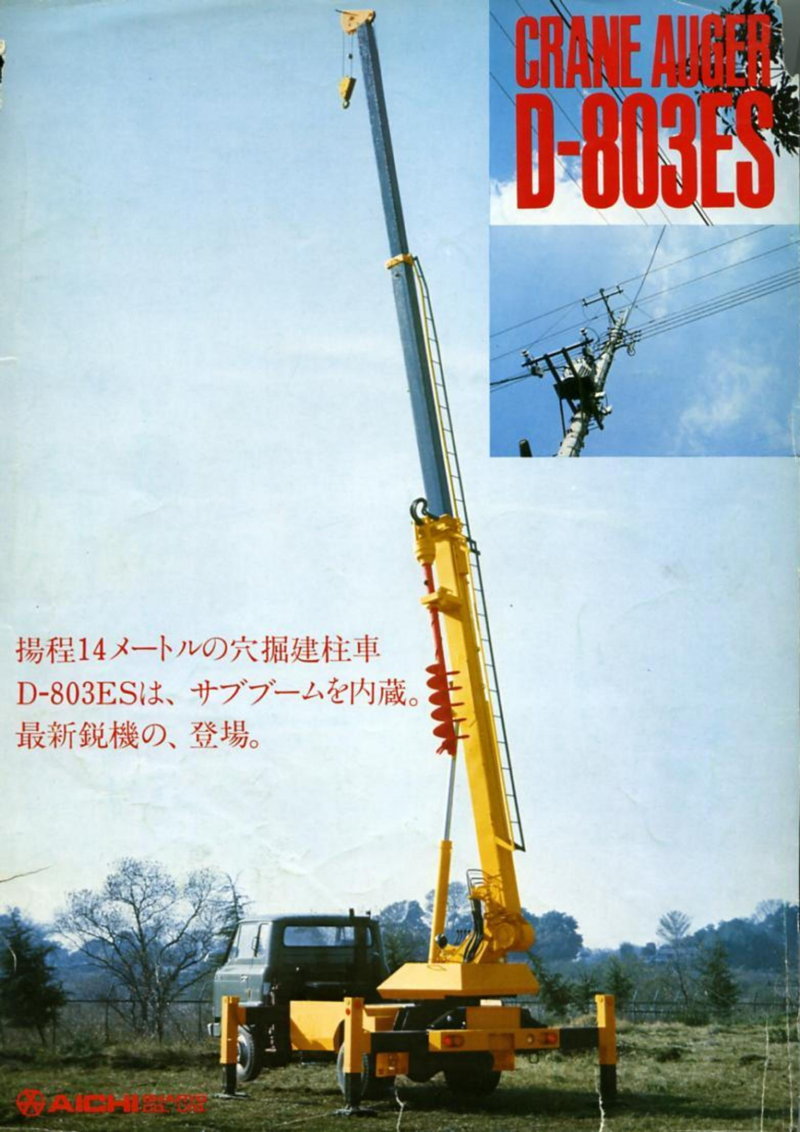
新登場のD-803ES。メインブームに引出式のサブブームを内蔵、地上揚程14メートル、吊上げ能力はメイン2.9トン、サブ1.0トンと、まさに高性能、穴掘建柱車の大物新鋭機です。しかも、4~4.5トンのショートホイールベース車に架装、小回りがきき現場から現場への機動性も抜群。そのうえ強力穴掘装置を装備、電気・通信工事の現場に文句なしの実力派です。また、穴掘装置は自動的に第2ブーム先端にセットされるので広い掘削範囲が思いのままに作業ができます。掘削トルクは590kg-m、掘削深度は4.5メートルと、きわめて頼りになる数値を誇っています。このほか、オーガーの格納はワイヤー自動巻込ロック方式なので簡単にして、確実です。さらに、アイチは安全面においても油圧制御安全装置、過巻警報装置、荷重計、始業警報器、オーガー過巻防止装置など万全を期しています。ウインチは下げ2段、オーガー回転速度は高低速2段に切り替えられるので、作業能率も一段と向上。このように、すべてに中型クラスをしのぐ機能のD-803ESは、穴掘建柱車に求められていたものを一気に解決した最新鋭機です。
