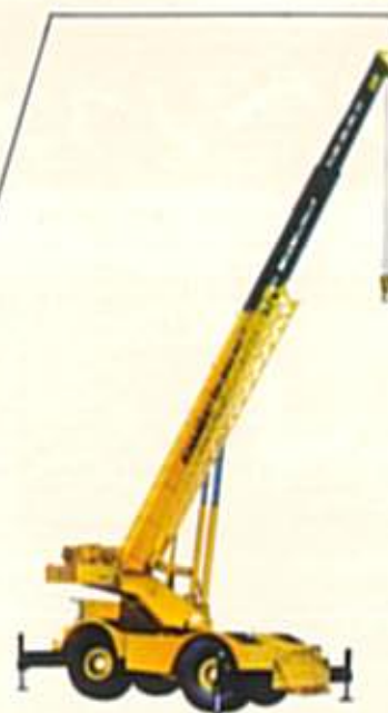
(GROVE RT 755 45トン吊不整地用クレーン)
