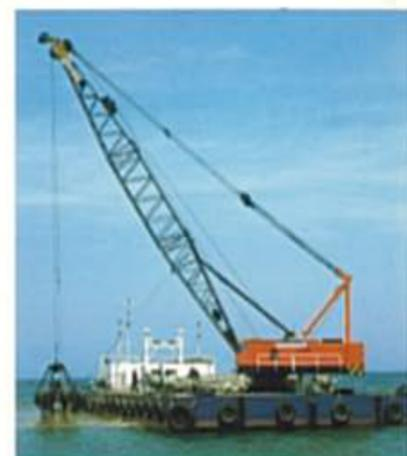
●堅ろうな建屋に加え、巻上げドラムのクラッチ、ブレーキ部分にはカバーを取付けてます。このため雨水などの浸入が防げ、天候に左右される海上作業での稼働時間が稼げます。
