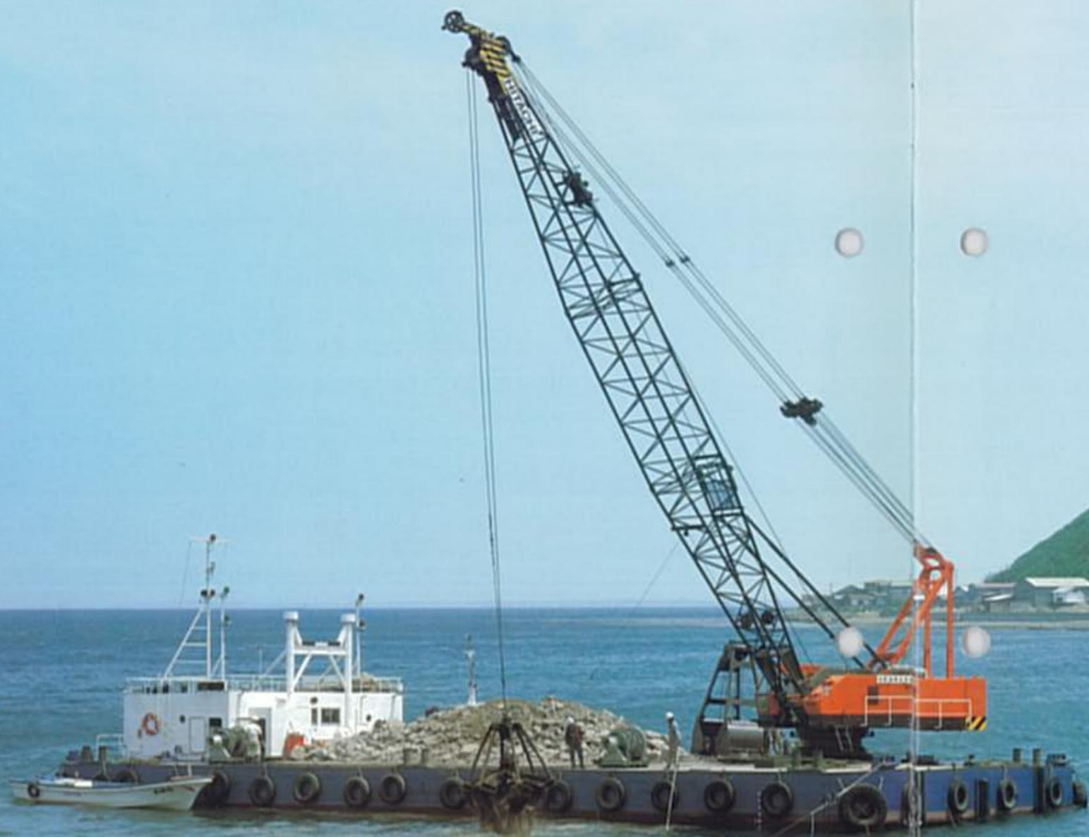
油圧式クレーンのパイオニア、日立。昭和46年、国産第一号機を手がけて以来、性能・機能ともに注目を集め、高い評価をいただいております。その豊富な経験と実績をもとに、蓄積した技術を結集。海上作業向けフローティングクレーンを数多く開発しています。群を抜く重量物荷役に加えて、作業範囲も広く、操作も容易、しかも優れた耐久性で…あらゆる作業能力が海事関連工事の条件を満たしています。護岸、防波堤の構築、漁礁の設置など幅広い海上作業で活躍している日立フローティングクレーン。卓越した一台を、作業に合わせてお選びください。
