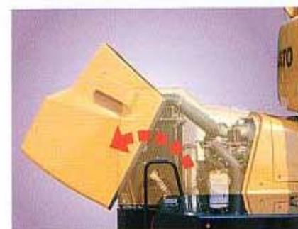
●開閉が簡単なチルト式エンジンカバー
