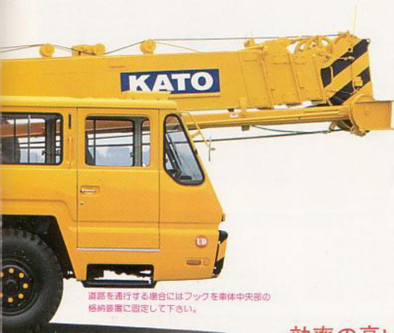
道路を通行する場合にはフックを車体中央部の格納装置に固定して下さい。
