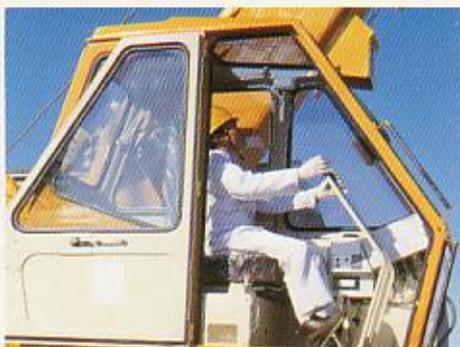
●見やすい制御機能…ACS<sup>®</sup>コンピュータを中心とした、すべての制御機器、レバー類は、オペレータの確認が容易にでき操作しやすい配置設計になっておりますから、つねに適確な作業状態を判断することができます。
