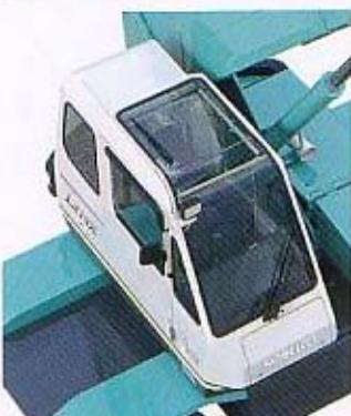
強い陽射しをカットするグリーンガラスを採用。前窓と天窓はサッシレスで、見通しのよい作業視界を確保。降雨時の上方視界をキープする天窓ワイパも装備しています。
