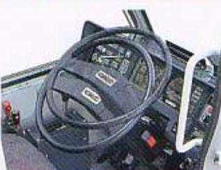
ホールド性もよく快適なフルリクライニングシート採用。操作レバーは角度が変えられるチルト式。しかも個別に長さも変えられます。ハンドルは上下・前後の2方向に調節できるチルト&テレスコピック機能付きです。
