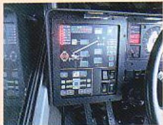
高信頼のモーメントリミッタが、ブームの起伏/伸縮、ウィンチ操作を安全制御。オーバーロードによる転倒事故や接触事故の防止に貢献します。
