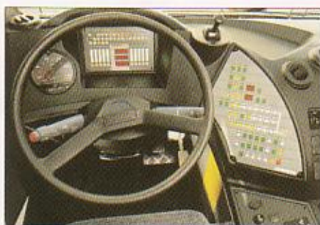
シャーシ運転席の操作パネルは、飛行機のcockpitを思わせるデザインで、見やすいデジタル表示。
