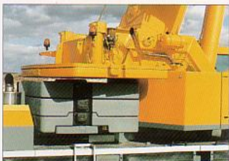
カウンタウエイトは、クレーンキャビン内より取付・取り外し操作が可能。
