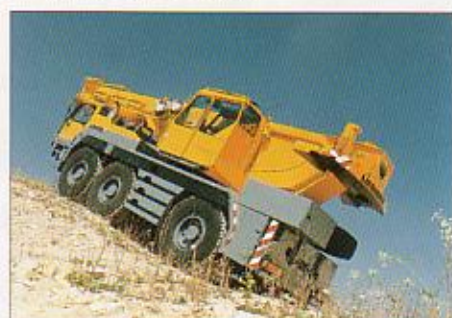
全機種軸重を12トンに設定。抜群の登坂能力と荒地での走行性能を確保し、場所を選びません。
