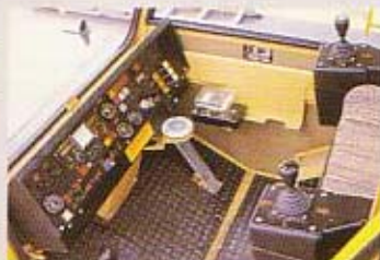
▲クレーンの各動作の制御が一体化され、操作しやすい運転室
