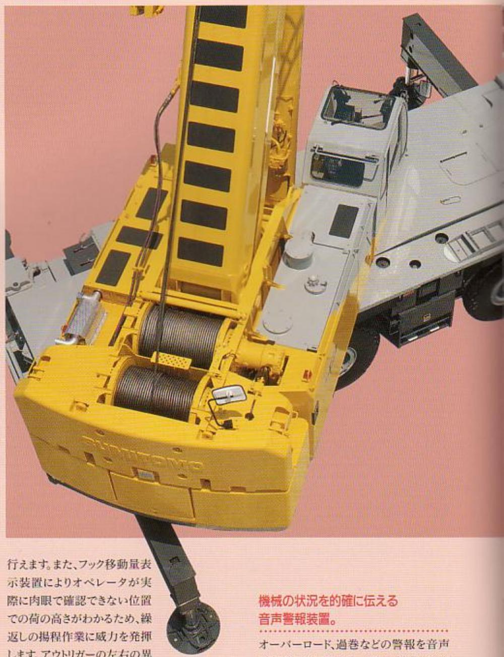
行えます。また、フック移動量表示装置によりオペレータが実際に肉眼で確認できない位置での荷の高さがわかるため、繰返しの揚程作業に威力を発揮します。アウトリガーの左右の異張出しに応じて、自動的に性能が切換り、旋回自動停止が働くため、限られた作業環境の中で最大限のクレーン作業が可能です。
