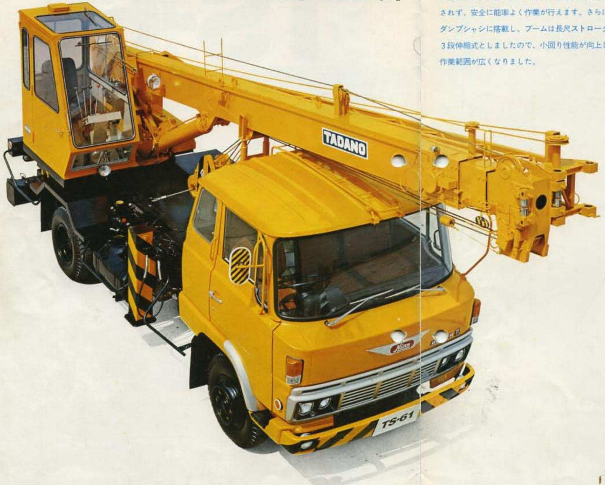
ニューモデルTS-61は、トラッククレーンにみられる前方領域でのつり上げ性能の低下を、見事に克服。フロントジャッキの装備により全周同一のつり上げ性能で作業できます。狭い現場でも進入方向が限定されず、安全に能率よく作業が行えます。さらに、ダンプシャシに搭載し、ブームは長尺ストロークの3段伸縮式としましたので、小回り性能が向上し、作業範囲が広くなりました。
