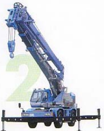
支点ピンを油圧で連結しブームを起す
